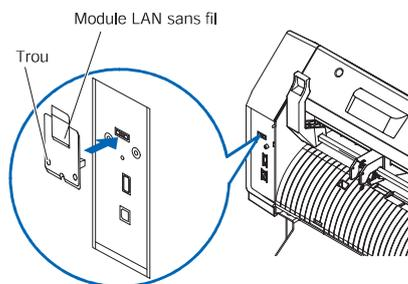
3. Fixez le couvercle du module LAN sans fil et le module LAN sans fil avec des vis à l'aide d'un tournevis cruciforme.
