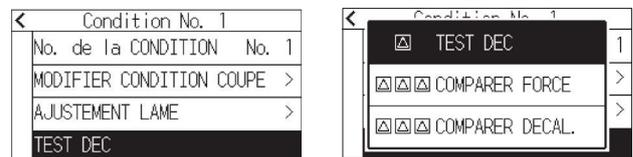
Vérifiez le résultat du test de coupe et ajustez la VITESSE, la FORCE et l'ACCELERATION pour un résultat optimal.
